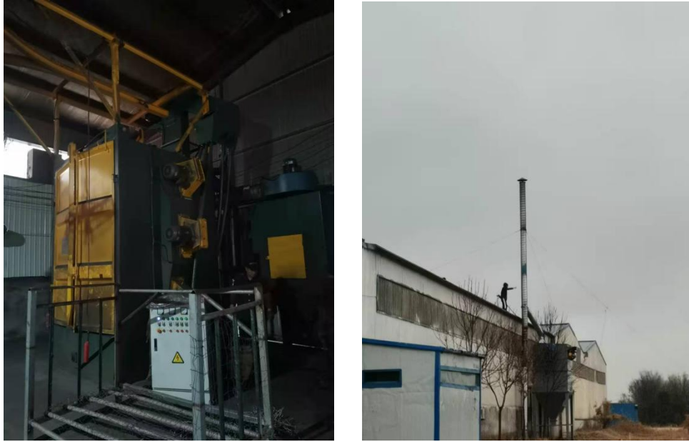
图 4-3 焊接、打砂工序：布袋除尘器+15 米排气筒
