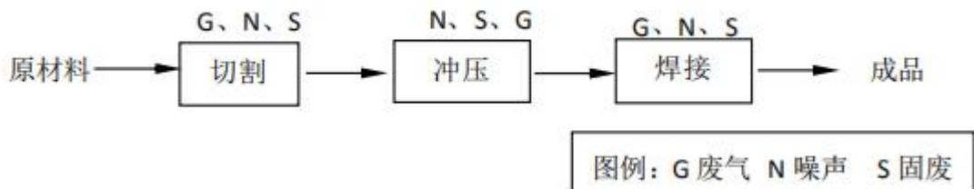
图 3-2 移动护栏生产工艺流程图及排污节点图
